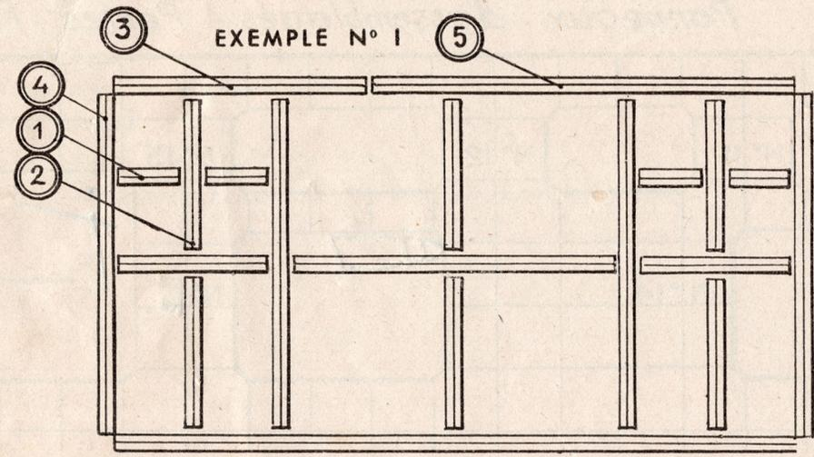
2° - Les bois d'assemblage N° 1 A, 2 A, 3 A, 4 A, 5 A, 6 A, 7 A, 8 A sont sectionnés à l'une de leurs extrémités à 90° et à l'autre extrémité par deux coupes à 45°, ce qui permet de les employer entre eux, pour le montage d'un pignon de toiture par exemple.
